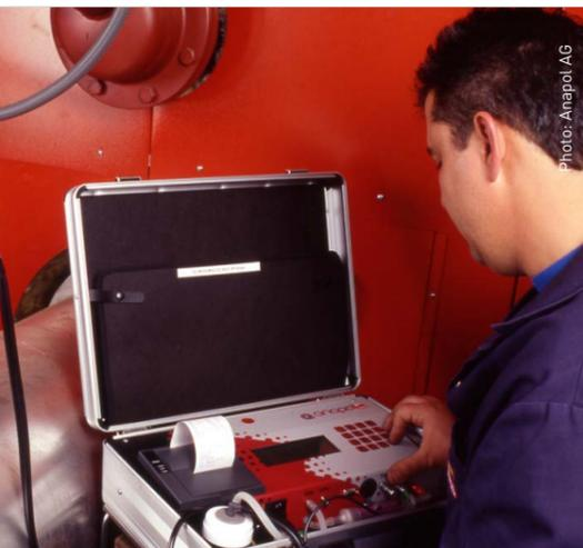
Mesure des gaz de combustion par le spécialiste en chauffage.
